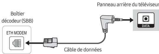
Connectez le port DATA du téléviseur au port ETH MODEM du STB (SBB) à l'aide du câble de données.
