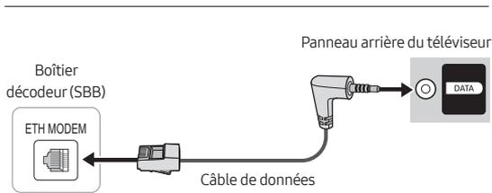
Connectez le port DATA du téléviseur au port ETH MODEM du STB (SBB) à l'aide du câble de données.
