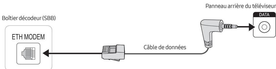
Connectez le port **DATA** du téléviseur au port **ETH MODEM** du STB (SBB) à l'aide du câble de données.
